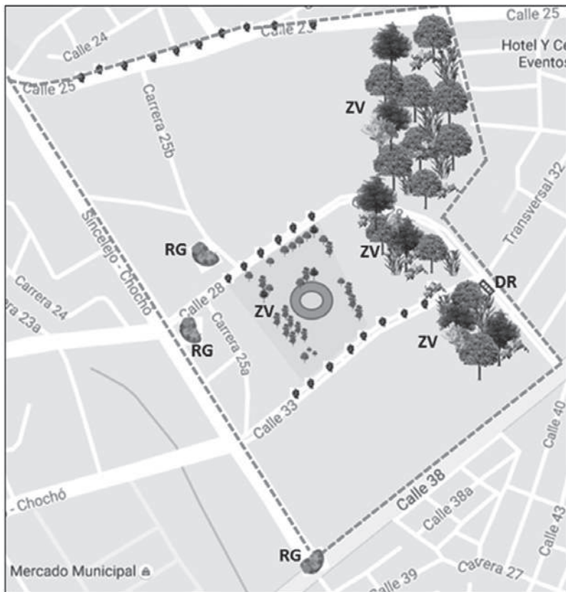
Imagen 52. Ubicación de áreas de acuerdo con lineamientos. ZV: zonas verdes, RG: Jardines de lluvia, DR: Drenaje.
