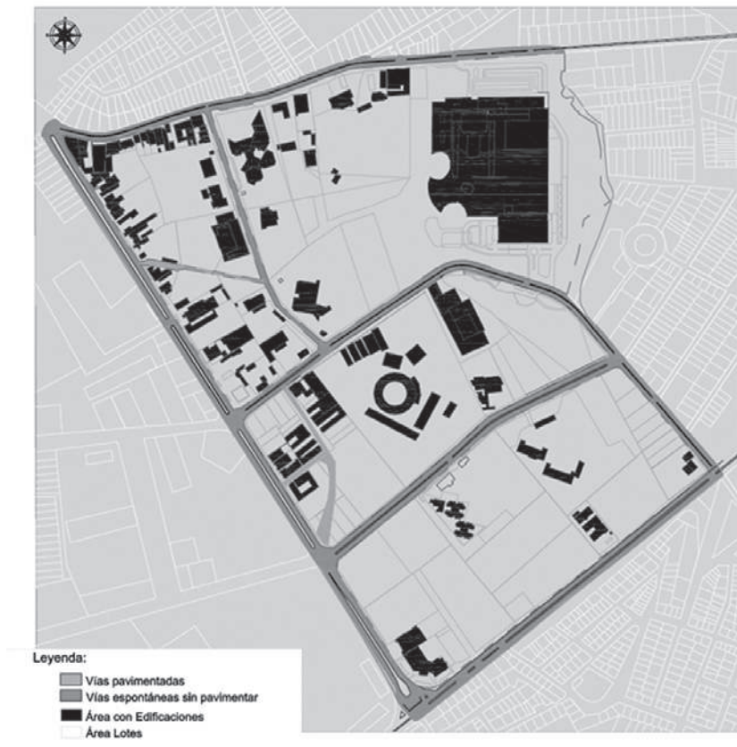
Imagen 32. Estado de las vías existentes en el polígono del CAM de Sincelejo.
